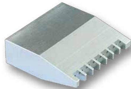
前面の小さな穴から音速に近い高速エアを吐出することで発生する吐出口前面のバキューム圧が、後方の周辺空気を大量に誘引し、高推力でフラットなブロー流を生成するブロー・ノズルです。
