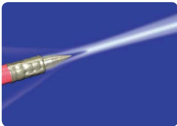
ジェット・ノズル付きスティ・ホース「SPN シリーズ」は、少量の供給圧縮空気から大容量ブロー（25 倍に増幅）を作り出し、冷却、吹き飛ばしなどに効果を発揮する最小サイズのノズルです。コンプレッサー・エアーの省エネ（圧縮空気削減率 30%）に貢献すると同時に、消費エアーが削減された分だけの騒音も軽減します。また、位置決め自由なスティ・ホースとの組合せにより、現場での設置が容易です。
