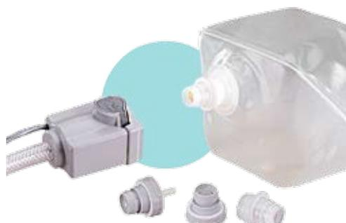
スマートカップリングは、**BIB** などの軟質包装や硬質容器の内容物の確認、プロセス管理を目的として使用されます。まず、容器へカップリングを接続する際、カップリング・ボディが容器側のカップリング・インサートに組み込まれた **RFID タグ** から製品データを受信します。次に、受信した製品データはリーダライタからケーブルを経由してコントロールシステムへ送られます。最後に、コントロールシステムでは確認された製品データをもとに内容物を確認し、オペレーターへの表示とあわせて次のプロセスへと進められます。
